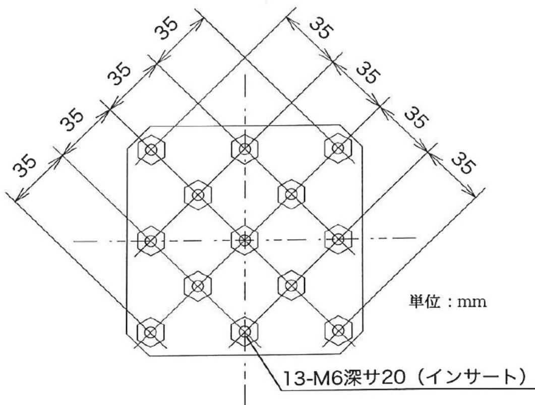
試料取付部は、板の上にナットが13個乗っているような形状になっています。この面が上下方向に振動します。左右、前後方向へ振動させたい場合は、治具で対応して頂きます。
