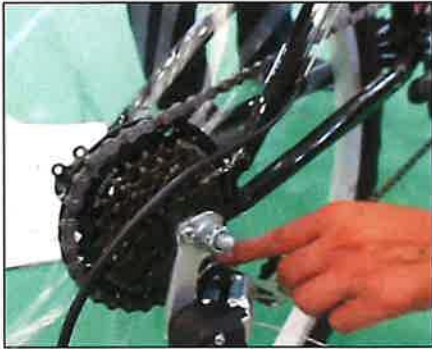
(3)チェーンが最小ギヤの外側に外れている例
