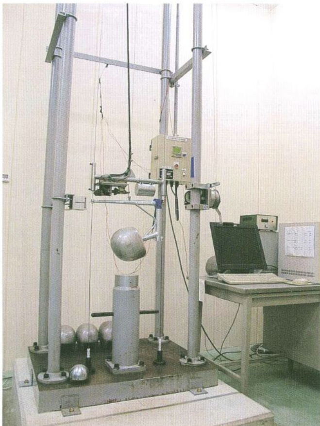
乗車用ヘルメット衝撃試験機 Impact tester for motor vehicle driver's helmets
