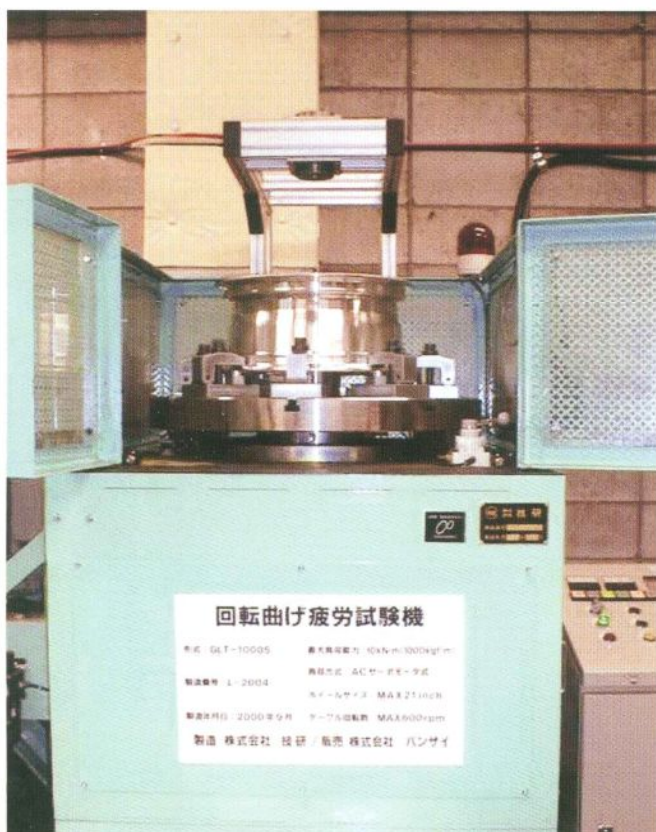
回転曲げ疲労試験機 Cornering fatigue test equipment
